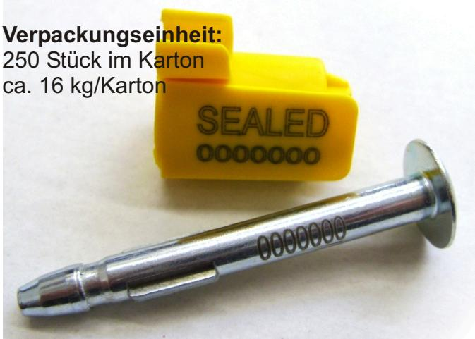
Die in die Hülse befindliche Ringfeder blockiert den Metallbolzen sofort beim Einschieben. Von nun an ist die Ringfeder von außen nicht mehr erreichbar und durch den Metallring hocheffizient geschützt.
